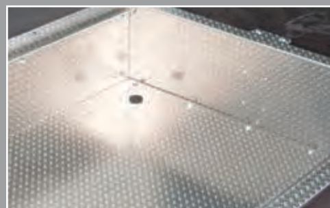
Platvormi keskele ehitatud sügav alumiiniumist laegas on ideaalne koht raskete ja suuremõõtmeliste esemete hoiustamiseks. Lisavarustusena saadaval ka alumiiniumist katted.
