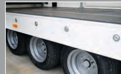
Kolmeteljeline lahendus on kujundatud nii, et haagise rattad asuvad platvormi all. See tagab sileda täislaia põhja, kuid samas on säilitatud ka madal raskuskesk.
