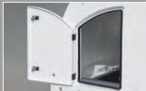
Eesmised juurdepääsuluugid nii vasakul kui paremal tagavad lihtsa juurdepääsu ja kiire sõiduki kinnituse.
