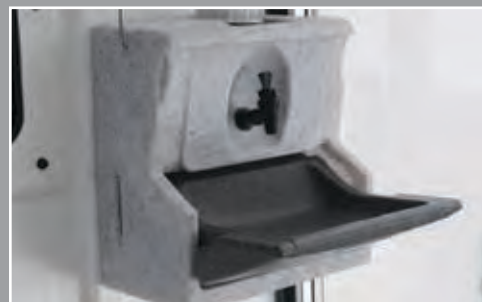
Kätepesukoht. 2,5 l soojaveepaak hoiab vee soojana ning kraanikaussi kogunev vesi on võimalik lihtsalt kõrvaldada.
