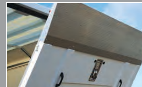
Täislai ja täiskõrge alumiiniumiga kaetud kvaliteetne lihtsalt lukustatav tagauks/ramp koos käepidemega.
