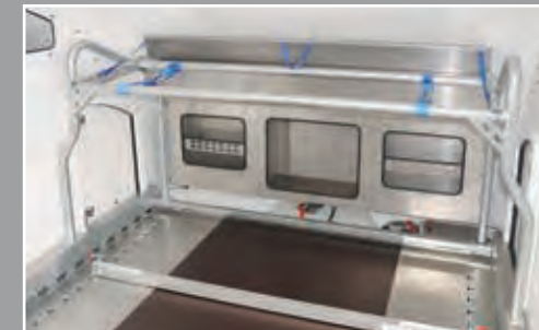
Terasest raam rehvide hoiustamiseks ja alumiiniumist tööpink. Lisaks koht kanistrite hoiustamiseks.
