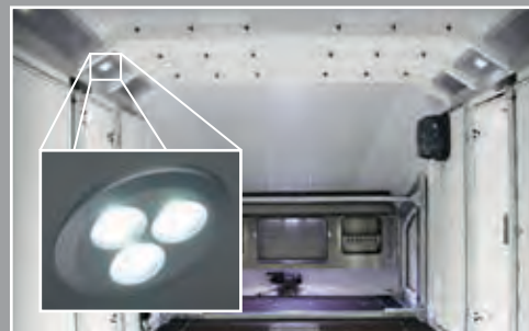
Sisemine LED valgustus, 8 lampi ja 2 kohtvalgustit on paigutatud alumiiniumist raami sisse. 12v aku.
