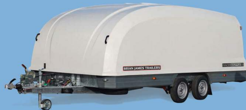
Aerodünaamiline monoliitne merekarpi meenutav disain vähendab tuuletakistust ja optimeerib pukseerimisel kütusekulu.
