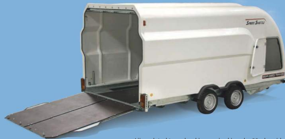
Liigendatud tagauksed ja esmised juurdepääsuluugid.
